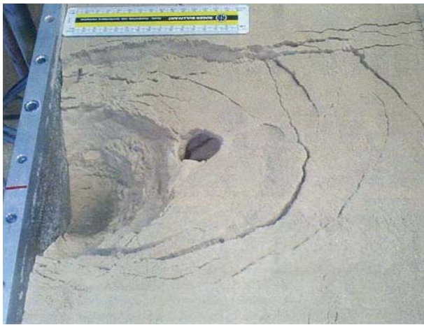
Arriba, fig. 14. Rotura del fondo y colapso del frente. A la izquierda, fig. 15. Ensayos en centrífuga, Univ. Cambridge. A la derecha, fig. 16. Ensayos en centrífuga, PWRI, Japón.
